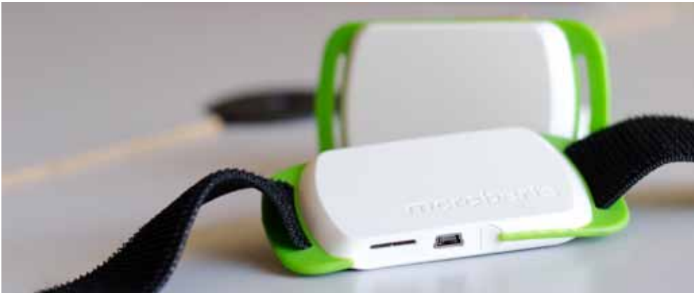
Afbeelding 1: Accelerometer zoals gebruikt in het onderzoek (fotocopyright McRoberts BV).
